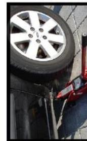
**2** Wagenheber an der dafür vorgesehenen Stelle ansetzen und Rad leicht entlasten. Position the lifting jack off the pressure and take the wheel.
