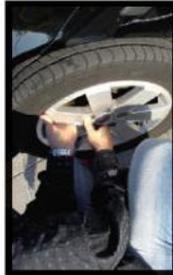
**7** Radauflagefläche reinigen. Clean the hub face and flange.
