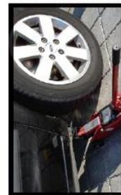
**2** Wagenheber an der dafür vorgesehenen Stelle ansetzen und Rad leicht entlasten. Position the lifting jack off the pressure and take the wheel.
