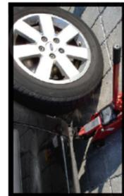
**2** Wagenheber an der dafür vorgesehenen Stelle ansetzen und Rad leicht entlasten. Position the lifting jack and take the pressure off the wheel.
