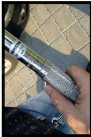
15 Drehmomentschlüssel auf korrekten Wert einstellen. Siehe dazu die Vorgaben des Fahrzeug- bzw. Felgenherstellers.
