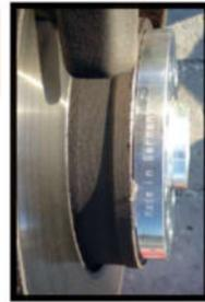
**10** Korrosionsschutzpaste im Bereich der Zentrierung dünn auftragen.
