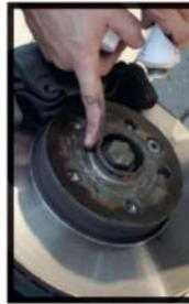
**11** Die neuen, längeren Befestigungsmittel auf Länge und Typ prüfen, vgl. umseitige Schraubenhinweise.
