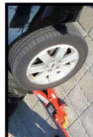
**2** Wagenheber an der dafür vorgesehenen Stelle ansetzen und Rad leicht entlasten. Position the lifting jack and take the pressure off the wheel.
