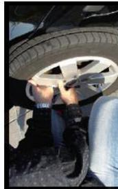
**7** Radanschlufäche reinigen. Clean the hub face and flange.
