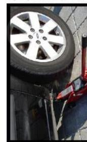
**2** Wagenheber an der dafür vorgesehenen Stelle ansetzen und Rad leicht entlasten. Position the lifting jack off the wheel.
