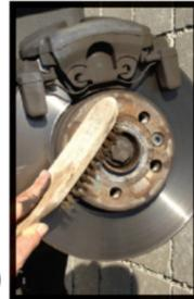
**8** Prüfen ob die Distanzscheibe vollflächig an der Nabenanlagefläche der Felge anliegt. Check that the spacer is completely in contact with the mounting surface of the wheel.
