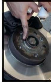
**11** Die neuen, längeren Befestigungsmittel auf Länge und Typ prüfen, vgl. umseitige Schraubenhinweise. Die neuen Radbefestigungsmittel müssen um Scheibenstärke länger als die ursprünglichen Befestigungsmittel sein. Check if the length and type of seating of the new and longer bolts are correct. (Have a look overleaf at the bolts advice. The new fixings need to be as long as the originals plus the thickness of the spacer. You may have to order new nuts/bolts separately.
