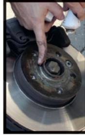
**11** Die neuen, längeren Befestigungsmittel auf Länge und Typ prüfen, vgl. umseitige Schraubenhinweise. Die neuen Radbefestigungsmittel müssen um Scheibenstärke länger als die ursprünglichen Befestigungsmittel sein. Check if the length and type of seating of the new and longer bolts are correct. (Have a look overleaf at the bolts advice. The new fixings need to be as long as the originals plus the thickness of the spacer.
