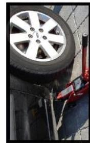
**2** Wagenheber an der dafür vorgesehenen Stelle ansetzen und Rad leicht entlasten. Position the lifting jack off the pressure and take the pressure off the wheel.
