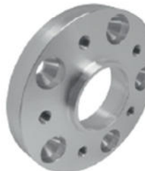
SYSTEM 3 Festverschraubtes System mit 2-facher Zentrierung und eingepressten Stehbolzen. Permanently bolted system with double centering and pressed-in stud bolts.
